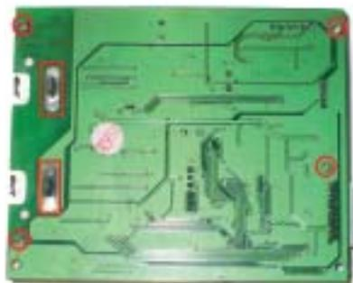
Nun hängt die Beleuchtung nur noch an zwei dicken Lötstellen, die die Hintergrundbeleuchtung mit Strom versorgen. Diese werden mit einem starken Lötkolben kurz erhitzt. Anschließend können Sie den weißen Kunststoffsockel aus den heißen Lötstellen herausziehen.
