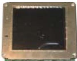
**2** Um die Metallabdeckung entfernen zu können, müssen Sie die kleinen Laschen auf der Rückseite des Displays leicht wegbiegen. Die Blende darf nicht beschädigt oder zerstört werden. Die Bohrungen an den Ecken eignen sich sehr gut, um das Display später im Gehäuse zu fixieren.
