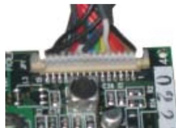
**2** Überprüfen Sie das Flachbandkabel des Displays. Die kleinen Kupferkontakte müssen in Richtung Platine zeigen. Wenn das Kabel bis zum Anschlag in die Buchse eingeführt wurde, kann man den braunen Klemmrahmen an die Buchse zurückschieben.
