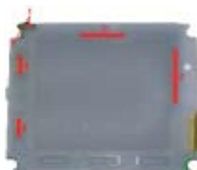
nen Sie vorsichtig den in Fäden gezogenen Kleber zwischen Platte und Display „anschneiden“. Hier müssen Sie sehr behutsam vorgehen, da das Display nicht zerkratzt werden soll. An den mit „2“ markierten Stellen befindet sich der Kleber.
